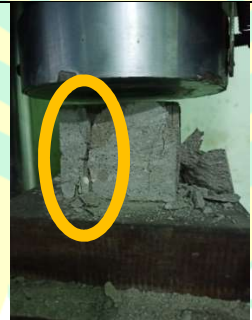
Kehancuran total kuat tekan variasi 3% pada 80 detik
