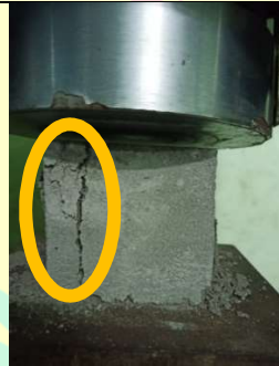
Kehancuran total kuat tekan variasi 2,5% pada 70 detik
