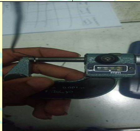
Pengukuran diameter kawat bendrat
