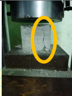
Kehancuran total kuat tekan variasi 2% pada 55 detik
