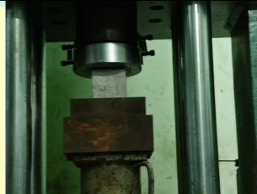
Proses pengujian kuat tekan
