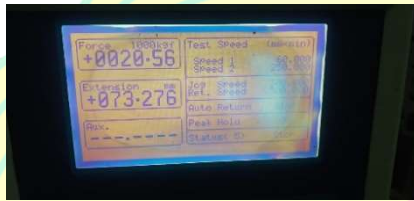
Contoh gambar hasil pengujian serat kawat 1
