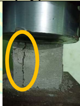
Kehancuran total kuat tekan variasi 0% pada 35 detik
