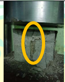
Kehancuran total kuat tekan variasi 3,5% pada 70 detik
