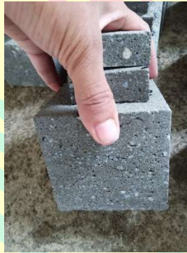
Hasil potongan dan penyebaran serat kawat bendrat pada paving block
