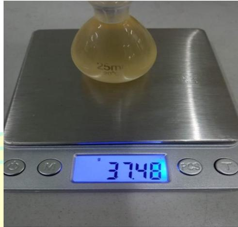
Gambar 3. 14 Pengukuran Densitas (sumber : dokumen Pribadi)
