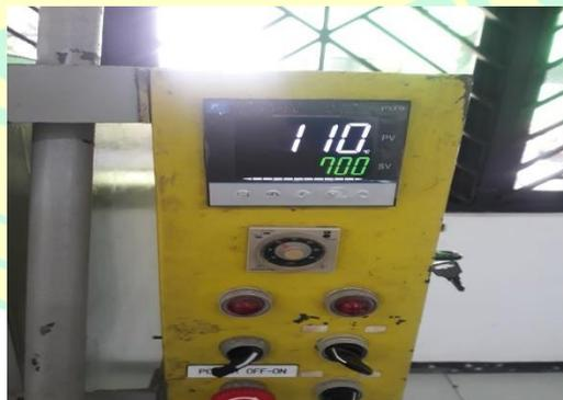
Gambar 3. 6 Penyetelan Suhu di Furnace (sumber : dokumen Pribadi)
