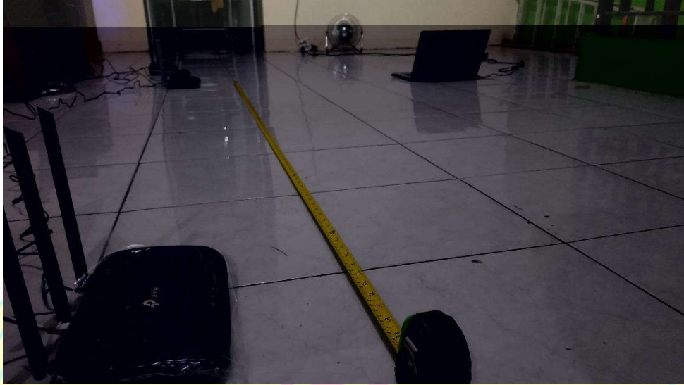
Pengukuran pada kondisi interferensi co-channel dan adjacent channel secara bergantian, jarak access point yang menginterferensi sejauh 2 meter dari access point utama
