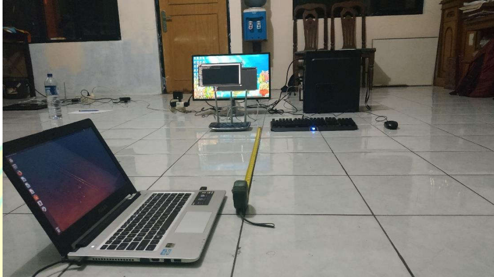
Pengukuran pada kondisi tanpa interferensi, jarak client 1 meter dengan access point
