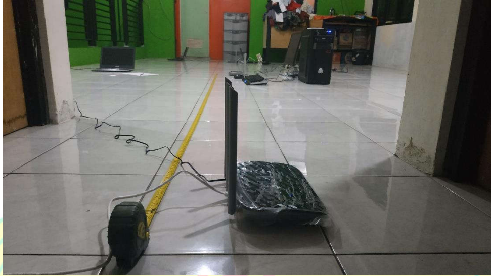
Pengukuran pada kondisi interferensi co-channel dan adjacent channel
