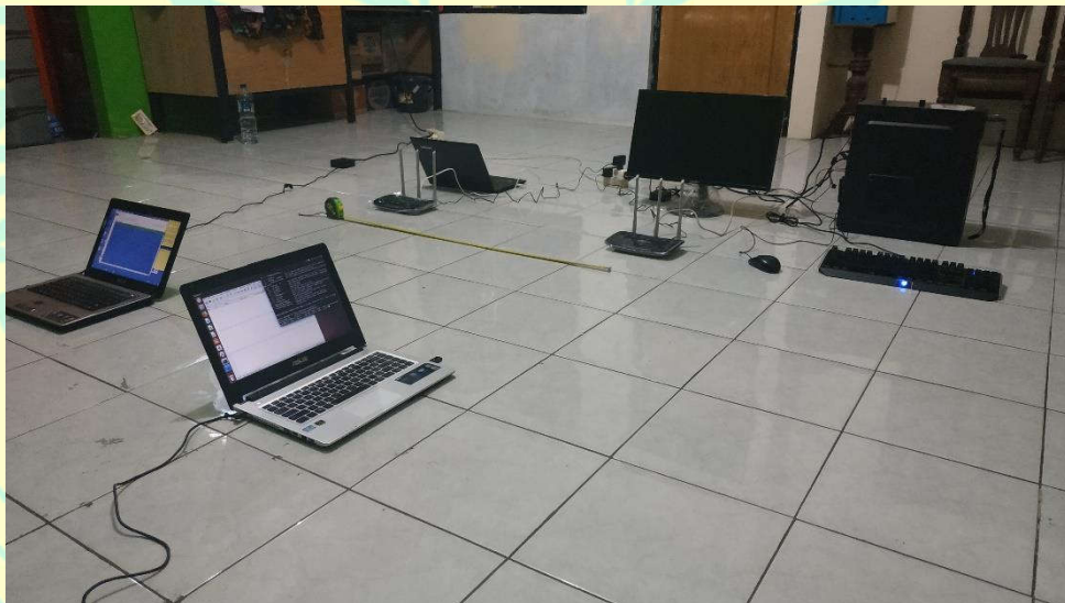
Pengukuran pada kondisi interferensi co-channel dan adjacent channel secara bergantian, jarak access point yang menginterferensi sejauh 1 meter dari access point utama
