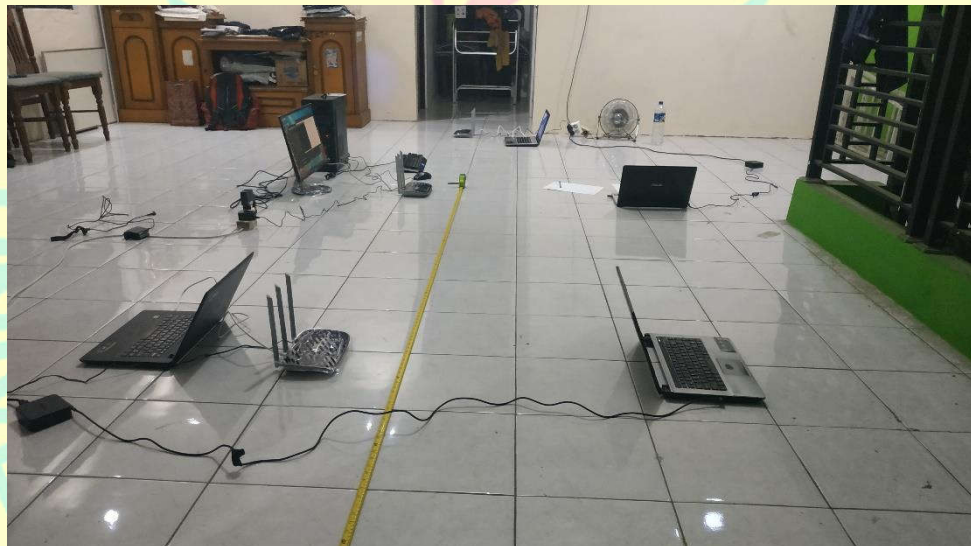
Pengukuran pada kondisi interferensi co-channel dan adjacent channel
