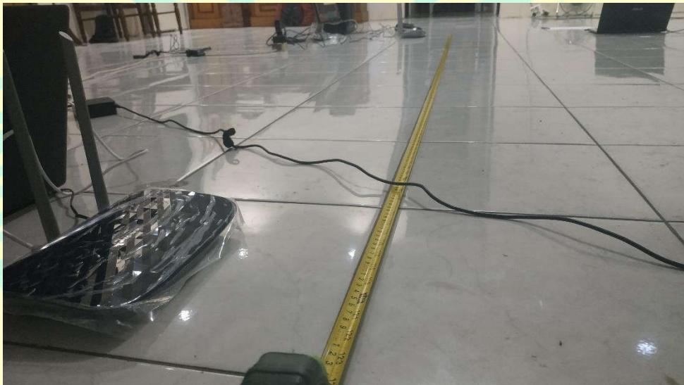
Pengukuran pada kondisi interferensi co-channel dan adjacent channel secara bergantian, jarak access point yang menginterferensi sejauh 3 meter dari access point utama
