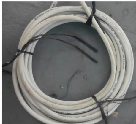
**Gambar 4.1 Sampel Kabel NYM 3 x 2,5 mm<sup>2</sup>**
