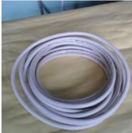
**Gambar 4.3. Sampel Kabel NYM 2 x 1,5 mm<sup>2</sup>**
