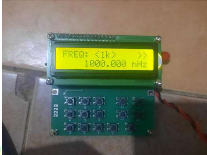
Gambar 4.6. Pembangkit sinyal ADF4351 yang sedang bekerja pada frekuensi 1 GHz.
