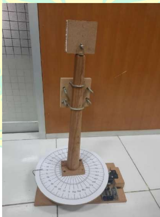
Gambar 4.4. Meja putar yang dibangun
