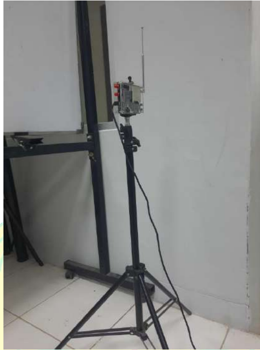
Gambar 4.3. Tiang penyangga antena penerima yang dibangun
