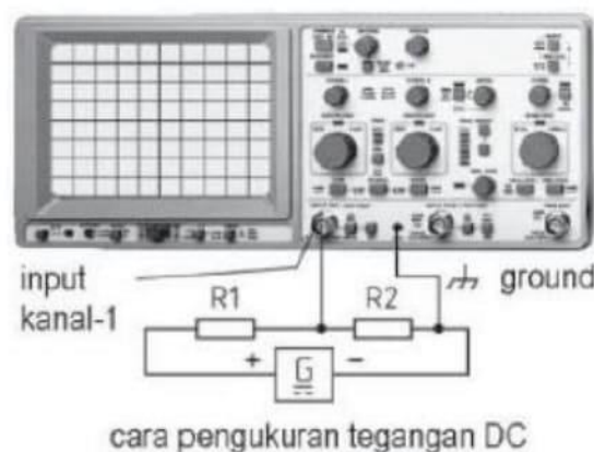
Gambar 11.3 Cara Pengukuran Tegangan DC
