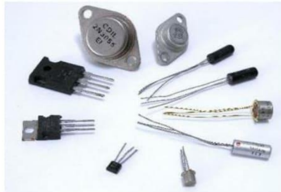
Gambar 5.18 Bangun Fisik dan Konstruksi Transistor Bipolar
