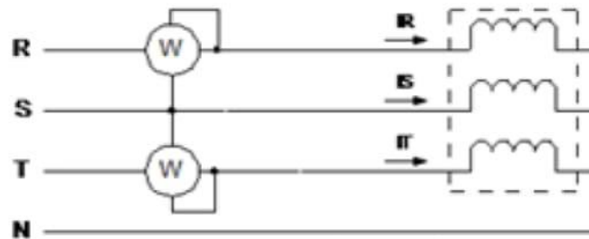
Gambar 10.10 Pengukuran Daya Tiga Fasa dengan Dua Wattmeter
