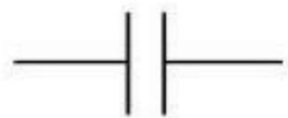
Gambar 5.28 Simbol Kapasitor Tetap
