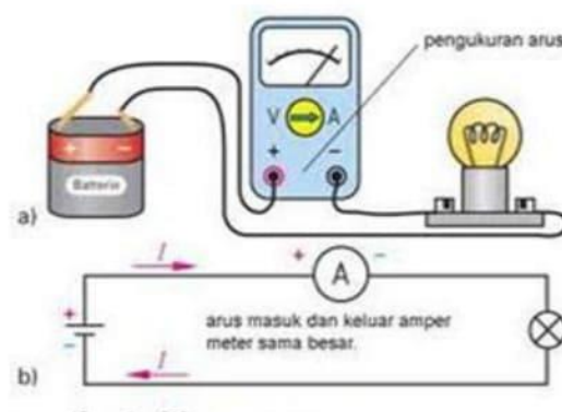
Gambar 9.16 Prinsip Pengukuran Arus
