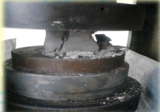
Mortar yang sudah diuji tekan
