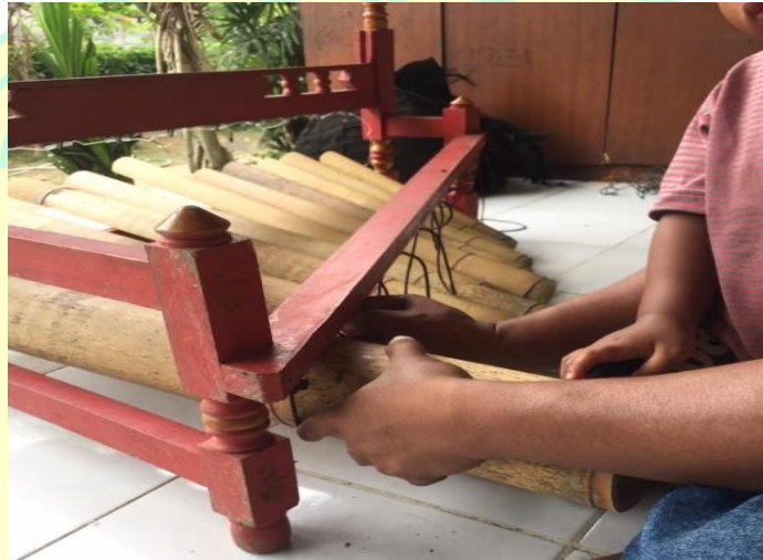
Gambar 47. Proses menaruh bilah bambu di pelawah Sumber : Alfrinda Clara, 3 September 2019
