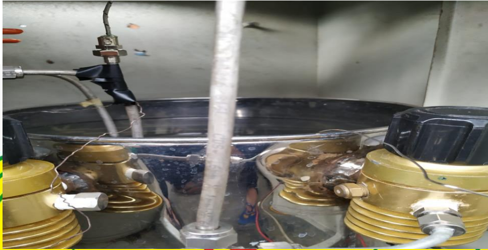
Gambar 3.7 Pengujian temperatur gas pada tubing setelah melewati heat exchanger . (Sumber: Dokumentasi pribadi)
