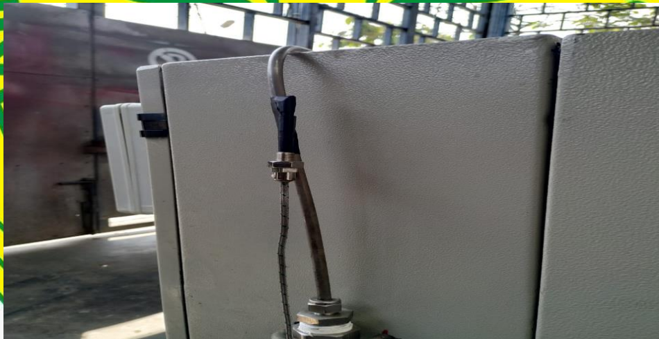
Gambar 3.6 Pengujian temperatur gas pada tubing sebelum melewati heat exchanger . (Sumber: Dokumentasi pribadi)
