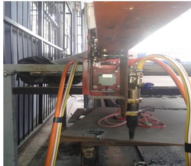
Gambar 4.13 Komponen mekanik pada *bracket torch*
