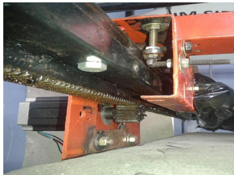
Gambar 4.10 Komponen mekanik pada penggerak sumbu Y
