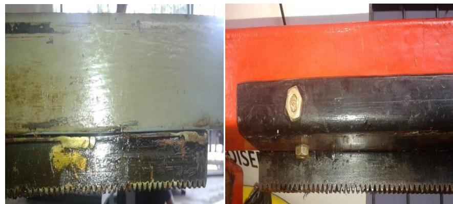
Gambar 4.8 Memasang *rack gear* pada lengan penggerak
