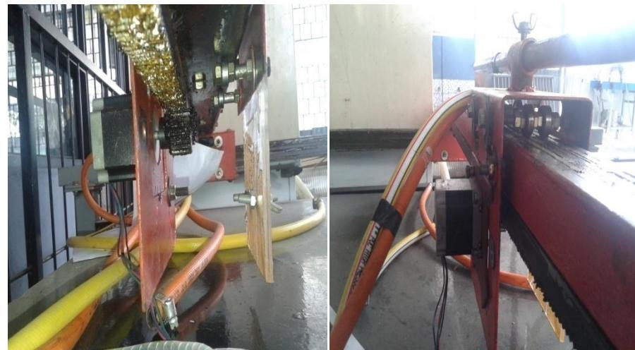
Gambar 4.11 Komponen mekanik pada penggerak sumbu X
