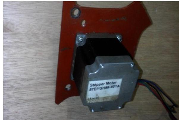
Gambar 4.7 Memasang motor pada *bracket*
