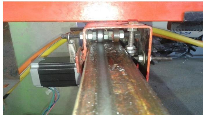
Gambar 4.9 Memasang *bearing* pada *bracket* penggerak
