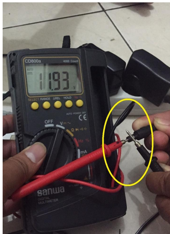
Gambar 4.4. Pengujian catu daya 12 Vdc
