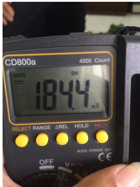
Gambar 4.11. Pengujian sensor 3 keadaan lembab
