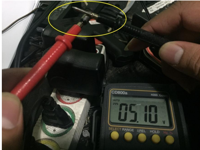
Gambar 4.3. Pengujian catu daya 5 Vdc
