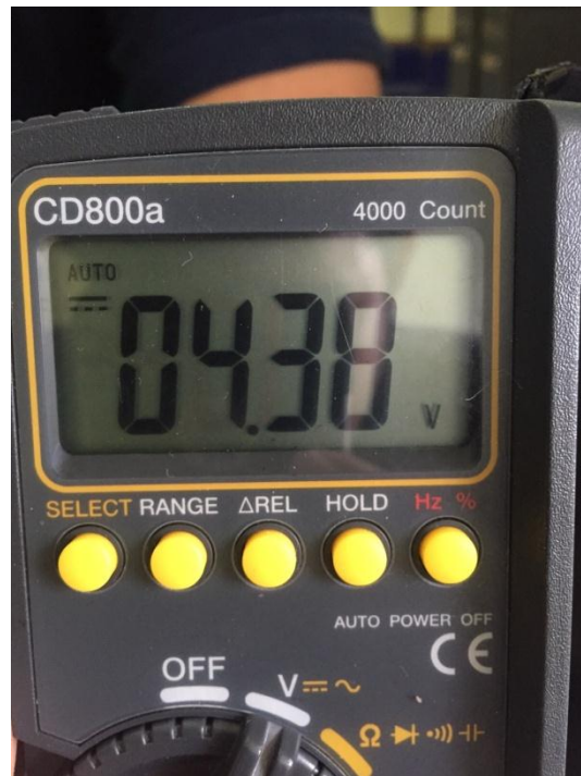
Gambar 4.6. Pengujian sensor 1 keadaan kering
