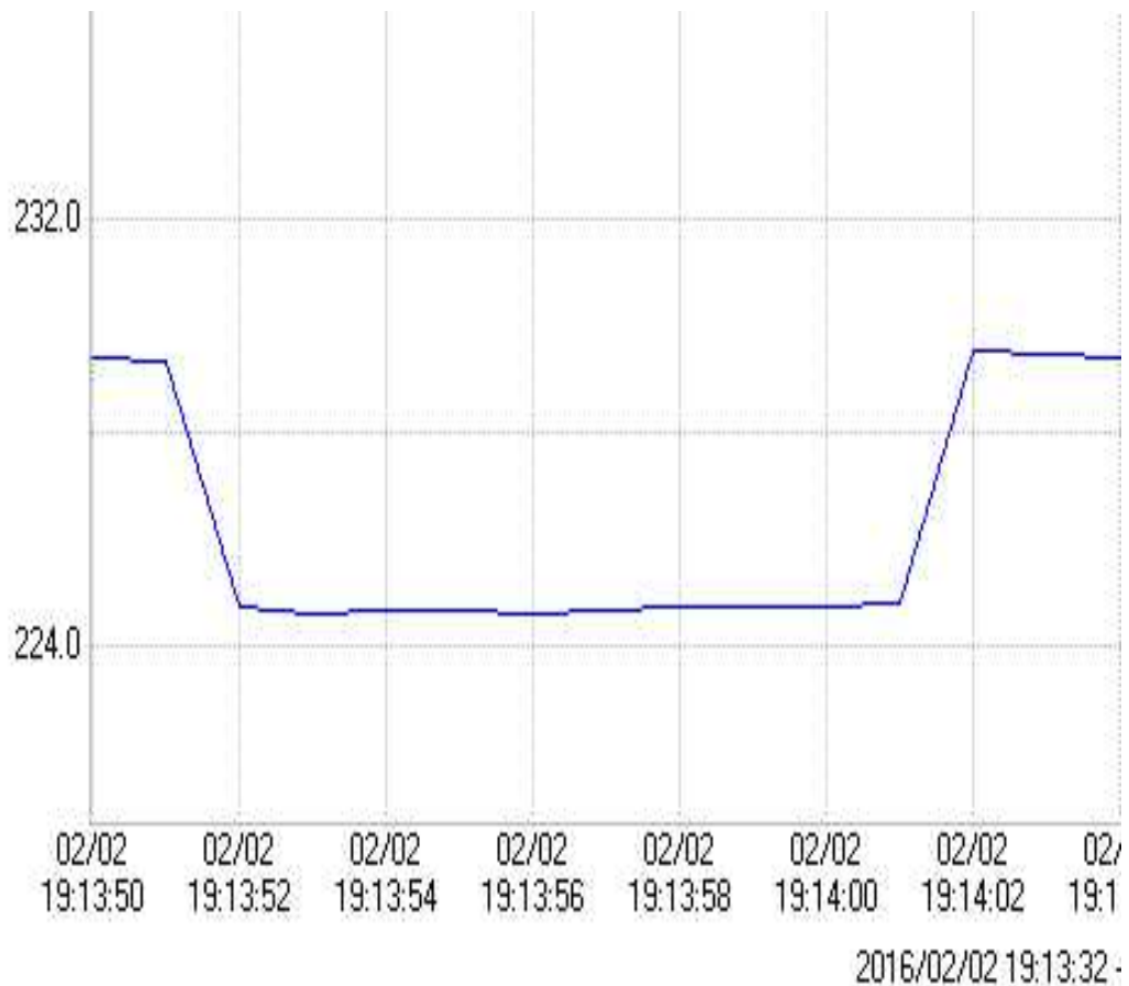
Gambar 1 Grafik Tegangan Saat Starting Motor Induksi Tanpa Beban Menggunakan Pengasutan Direct On Line Hubung Delta
