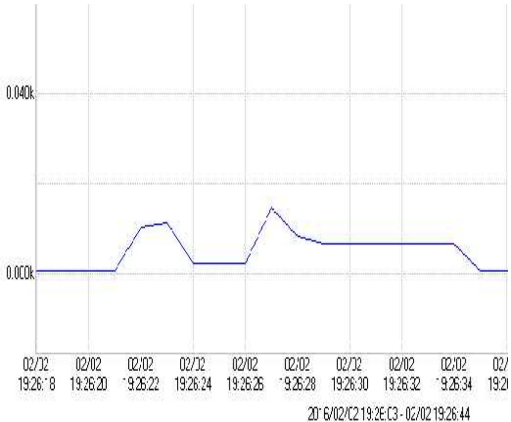
Gambar 8 Grafik Arus Saat Starting Motor Induksi Tanpa Beban Menggunakan Pengasutan Star Delta Otomatis
