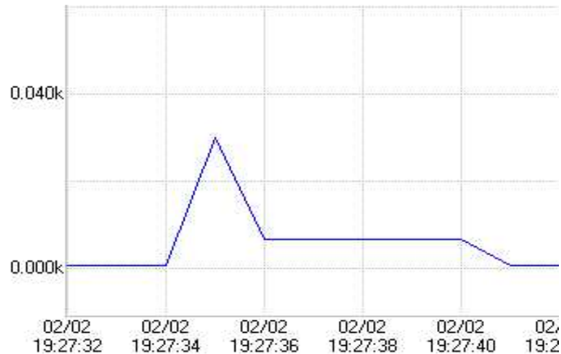
Gambar 4 Grafik Arus Saat Starting Motor Induksi Berkapasitas Tanpa Beban Menggunakan Pengasutan Direct On Line Hubung Delta
