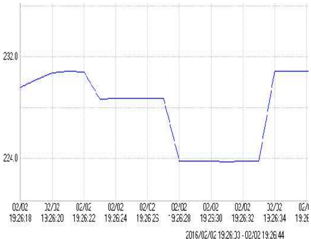
Gambar 7 Grafik Tegangan Saat Starting Motor Induksi Tanpa Beban Menggunakan Pengasutan Star Delta Otomatis
