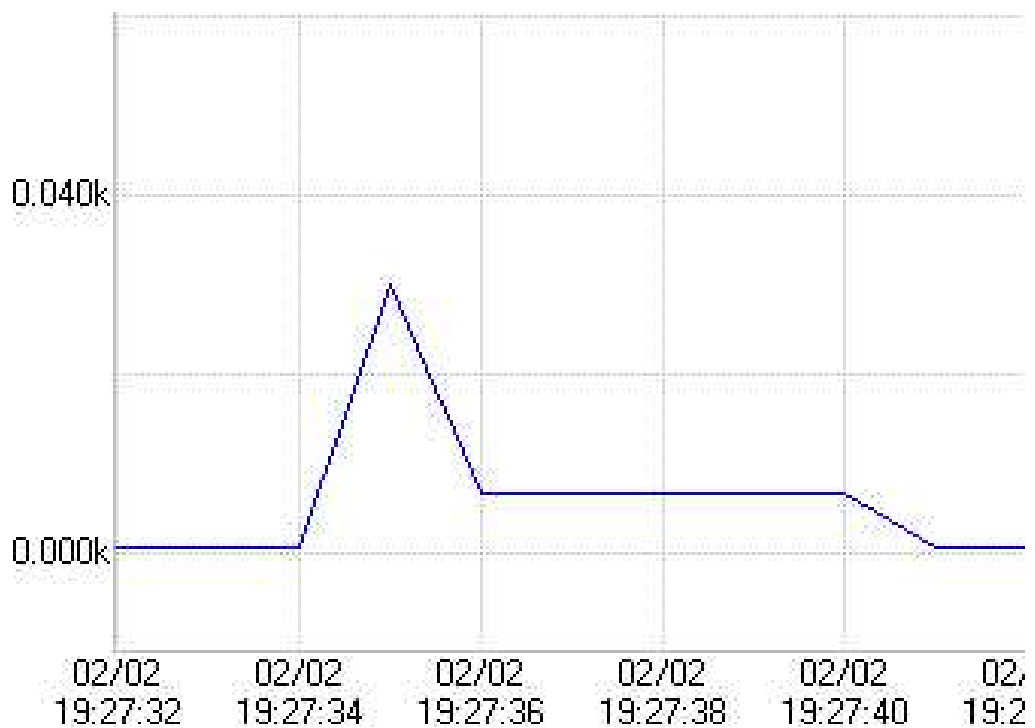
Gambar 3 Grafik Tegangan Saat Starting Motor Induksi Berkapasitas 3 HP Tanpa Beban Menggunakan Pengasutan Star Delta Otomatis
