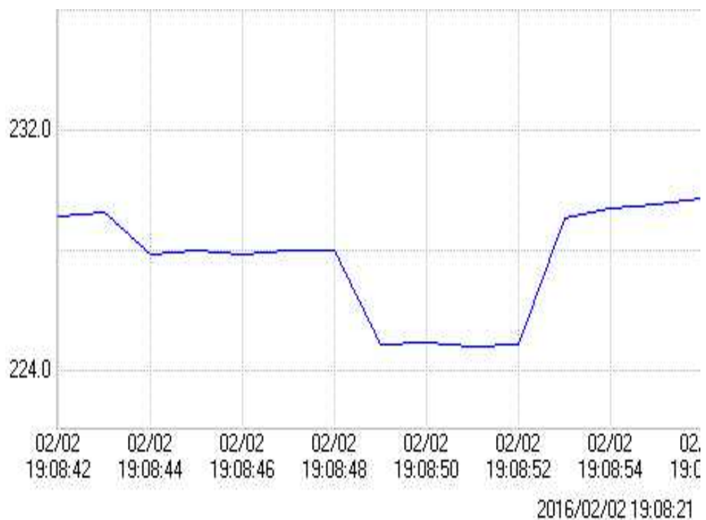
Gambar 5 Grafik Tegangan Saat Starting Motor Induksi Tanpa Beban Menggunakan Pengasutan Star Delta Otomatis
