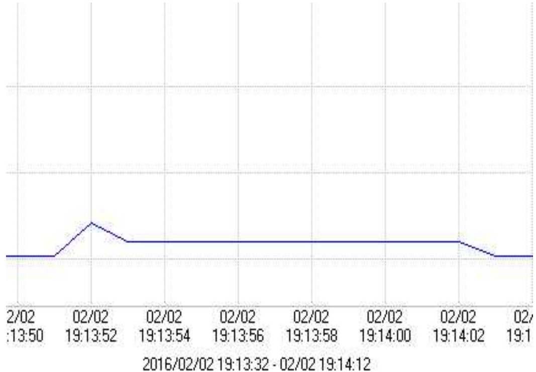
Gambar 2 Grafik Arus Saat Starting Motor Induksi Berkapasitas 1 HP Tanpa Beban Menggunakan Pengasutan Direct On Line Hubung Delta
