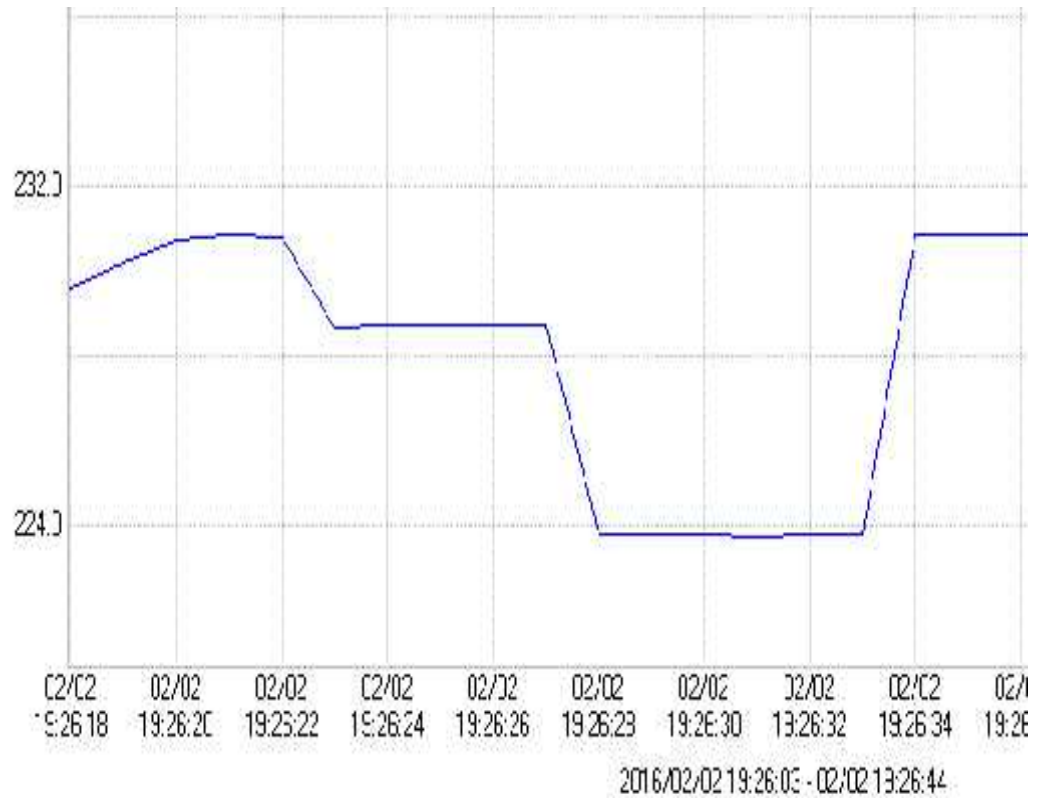
Gambar 7 Grafik Tegangan Saat Starting Motor Induksi Berkapasitas 3 HP Tanpa Beban Menggunakan Pengasutan Star Delta Otomatis
