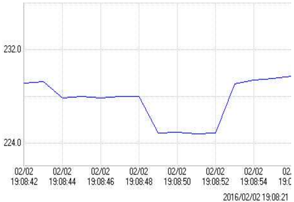
Gambar 5 Grafik Tegangan Saat Starting Motor Induksi Berkapasitas 1 HP Tanpa Beban Menggunakan Pengasutan Star Delta Otomatis
