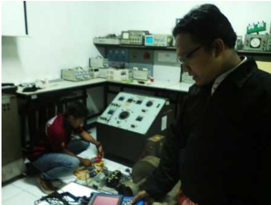
Foto Pengukuran voltage sag menggunakan Hioki 3197 Power Quality Analyzer 3197 pada Motor Induksi Berkapasitas 2.2 KW
