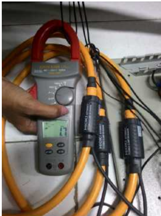
Foto Pengukuran Arus Menggunakan Tang Ampere
