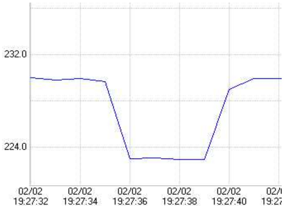
Gambar 3 Grafik Tegangan Saat Starting Motor Induksi Berkapasitas 3 HP Tanpa Beban Menggunakan Pengasutan Star Delta Otomatis
