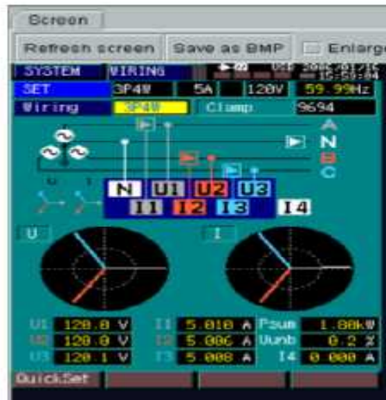
Gambar 3.11 Tampilan wiring awal Pada Power Quality Analyzer HIOKI 3197
