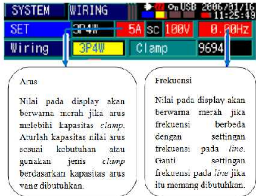
Gambar 2.33 Tampilan System Untuk Verifikasi Nilai Pengukuran
