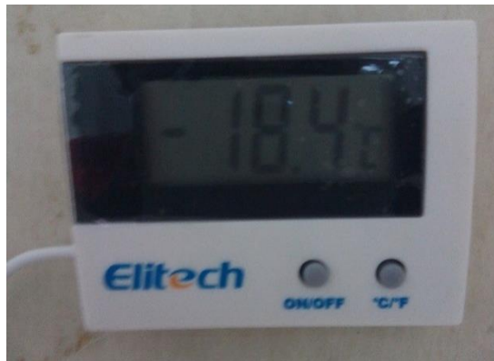
Gambar. 3.41 Alat ukur termometer digital untuk mengukur temperatur dalam kabin
