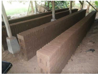
Gambar 2.9. Pengeringan Bata Merah
