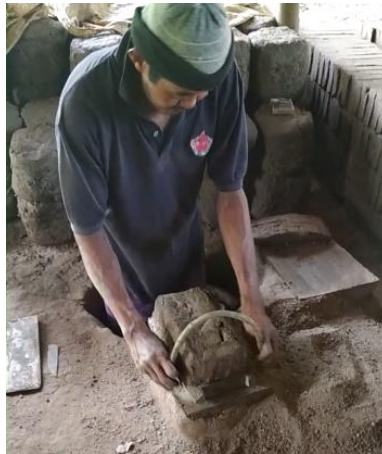
Gambar 2.8. Pembentukan Bata Merah
