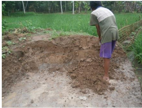
Gambar 2.7. Penggalian Bahan Pembuatan Bata Merah
