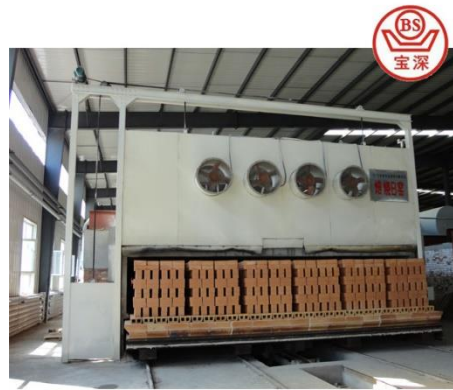
Gambar 1.1. Pembakaran Dengan Oven Sumber : Internet
