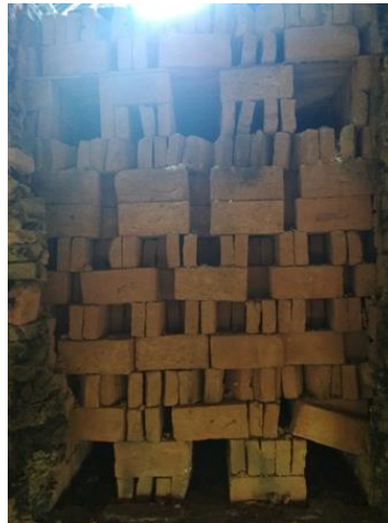
Gambar 2.10. Bata Merah Setelah Dibakar Dalam Tungku
