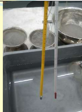
Suhu pada botol dan wadah air tidak lebih dari 25^{\circ}
