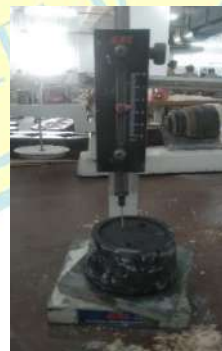
Jarum vicat mencapai pada penurunan 25 mm
