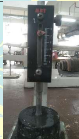
Penurunan pada vicat (6mm)
