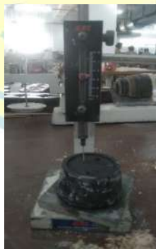
Jarum vicat mencapai pada penurunan 25 mm
