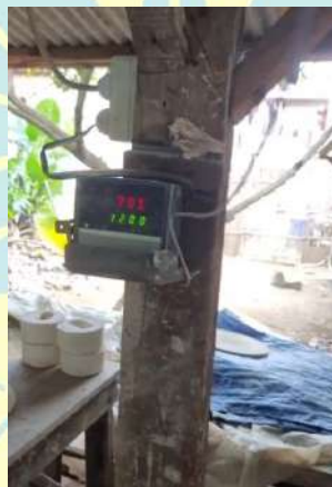
Gambar 4 Suhu Pembakaran Kulit Durian hingga 700 °C
