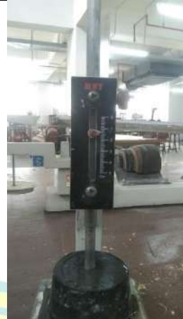
Penurunan pada vicat (13 mm)
