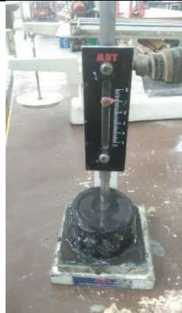
Penurunan pada vicat (8 mm)
