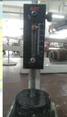
Penurunan pada vicat (6mm)
