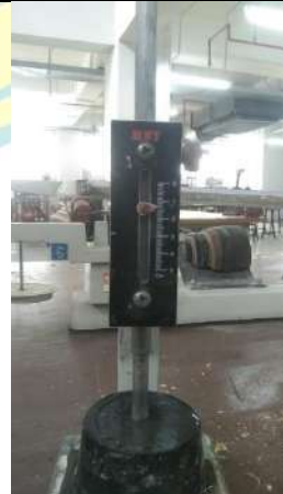
Penurunan pada vicat (12 mm)
