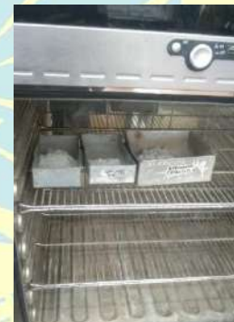
Oven Benda Uji setelah dicuci
