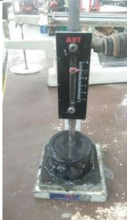
Penurunan pada vicat (9 mm)
