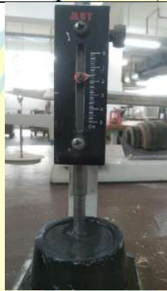
Penurunan pada vicat (16 mm)
