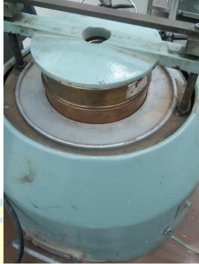
Gambar 3.9 Melakukan Pengayakan Abu Kulit Durian No. 200
