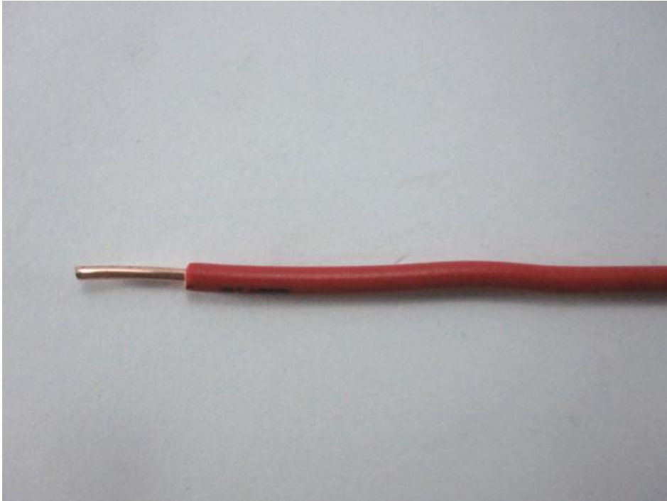
Gambar 4.7 Sampel kabel uji NYA
