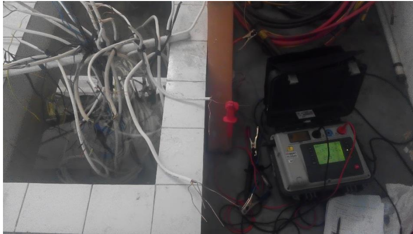
Gambar 4.4 Pengujian Tahanan Isolasi Kabel NYM 3 x 2,5 mm 2
