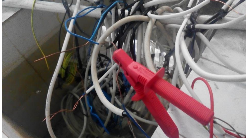
Gambar 4.2 Pengujian Tahanan Isolasi Kabel NYA 1 x 2,5 mm 2
