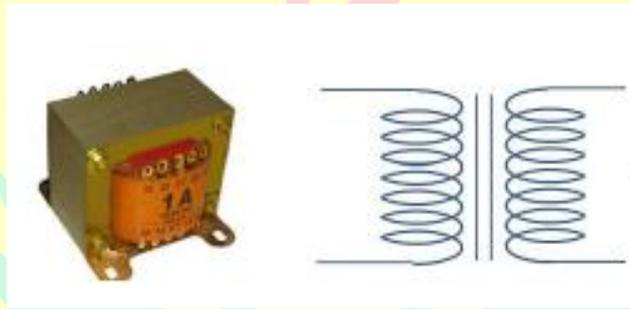
**Gambar 2.13** Tranformator/Trafo (Kiri), Simbol Trafo (Kanan)
