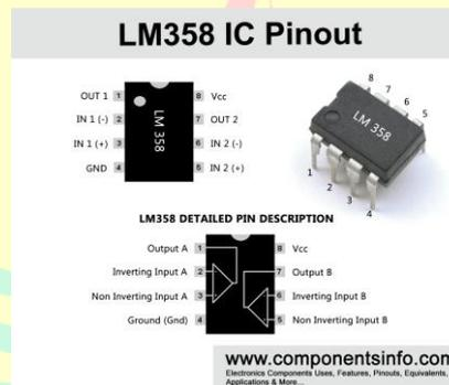
**Gambar 2.22 IC Op-Amp LM358 (Kanan), Simbol Op-Amp (Kiri)**
